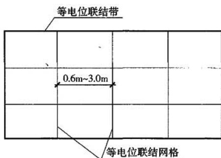
图1 等电位联结带与等电位联结网格
