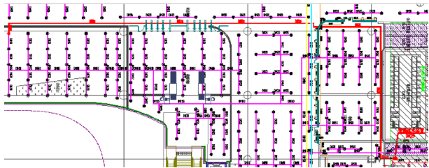
图1 最不利点洒水喷头 (左侧)、末端试水装置 (右侧) 位置示意图
