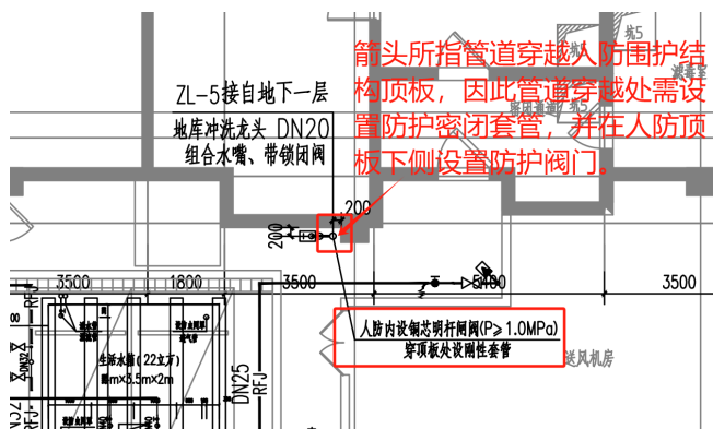
图3 管道穿越人防工程顶板做法
