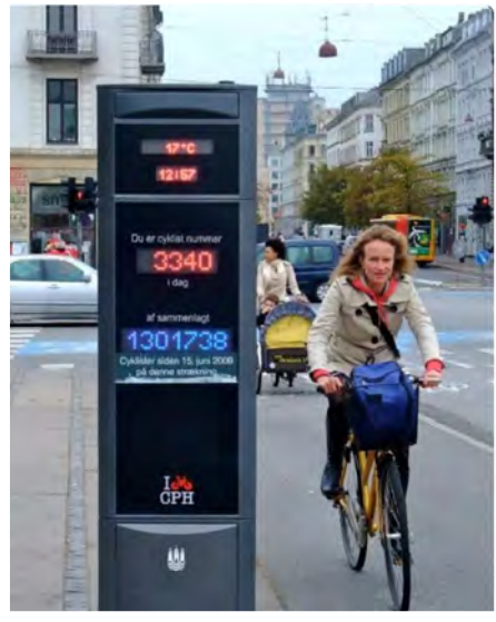
【丹麦自行车绿波】 为了突出对骑行者的友好，丹麦哥本哈根的许多路口推行独立的自行车信号灯，并给予至少4秒的信号优先；同时，部分自行车流量大的道路还设有自行车计数器，以便骑行者更好地规划路线，避免自行车拥堵。目前，哥本哈根自行车绿波2.0版也正在测试，它甚至能记录自行车车队的传感器，当车队接近交叉口时，绿灯时间会自动进行动态延长或调整。
