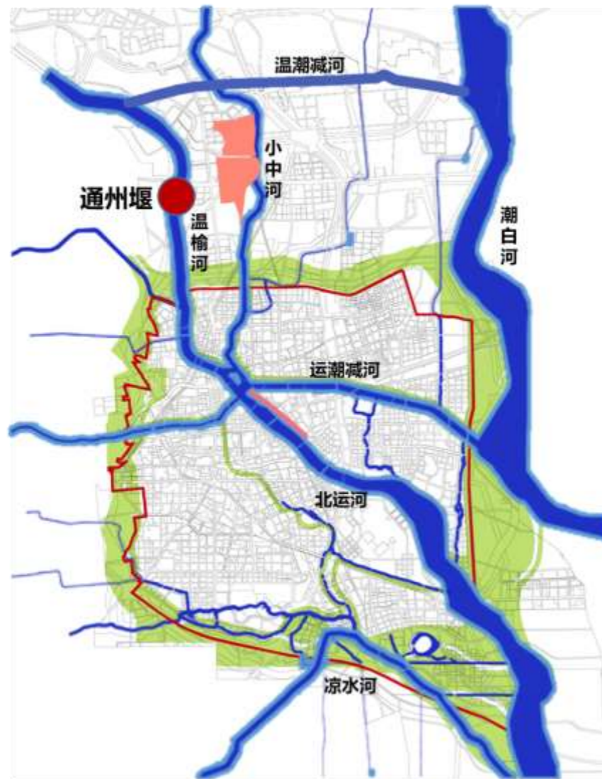
通州堰分洪体系示意图（图片来自副中心控规）
