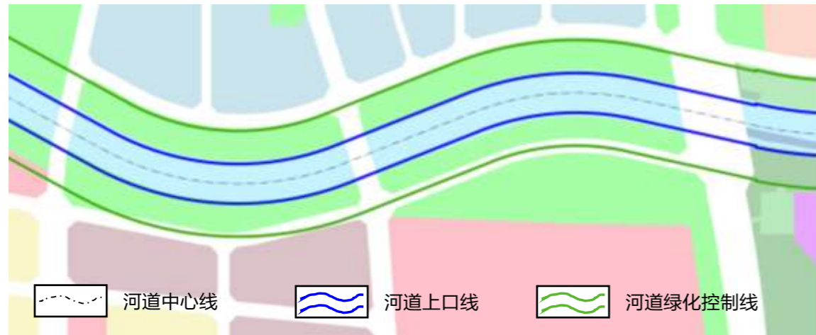
河道中心线、上口线、绿化控制线平面示意图（图片为课题组绘制）
