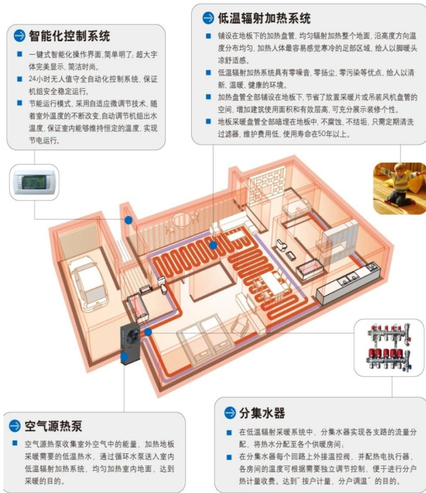
图7 空气源热泵+地板辐射采暖系统构成
