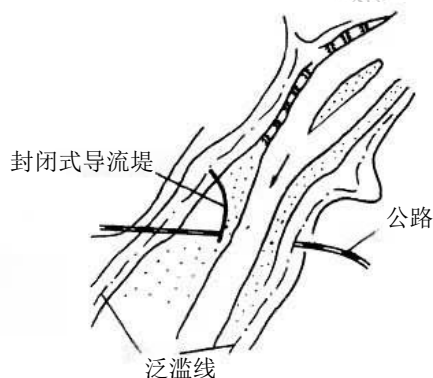
图 5.4.8-1 封闭式导流堤
