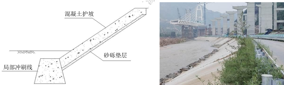
图 4.2.4 混凝土护坡
