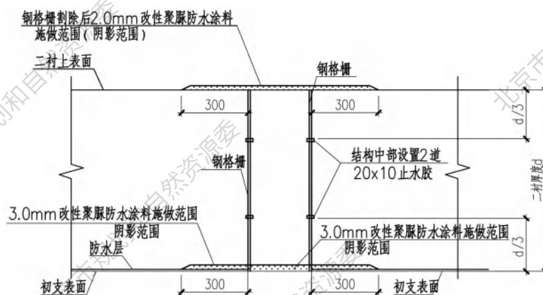
图 17 钢筋格栅穿防水层构造剖面图
