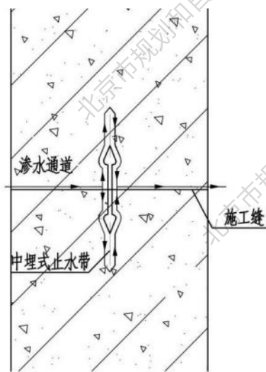
图 20 中埋式止水带防水原理图配图
