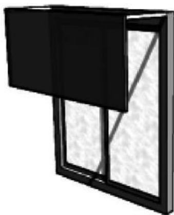
图 B.3.1-3 挡板外遮阳特征值示意图
