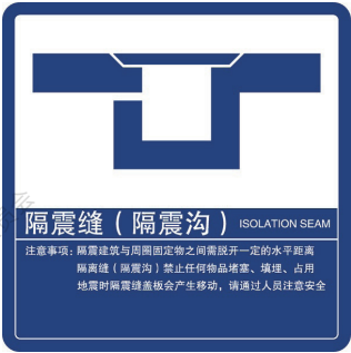
图 N.0.6-3 隔震缝 (隔震沟) 标识
