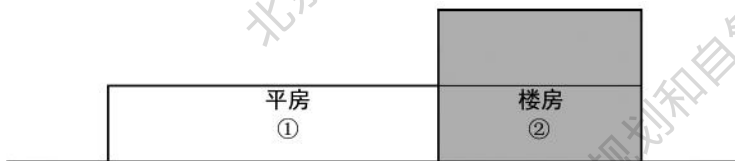
图 4.2.7 地上 2 层以上房屋建筑与平房相连情形的示例
