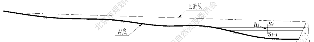
图 L.1 用等高线法计算拦挡坝库容纵断面
