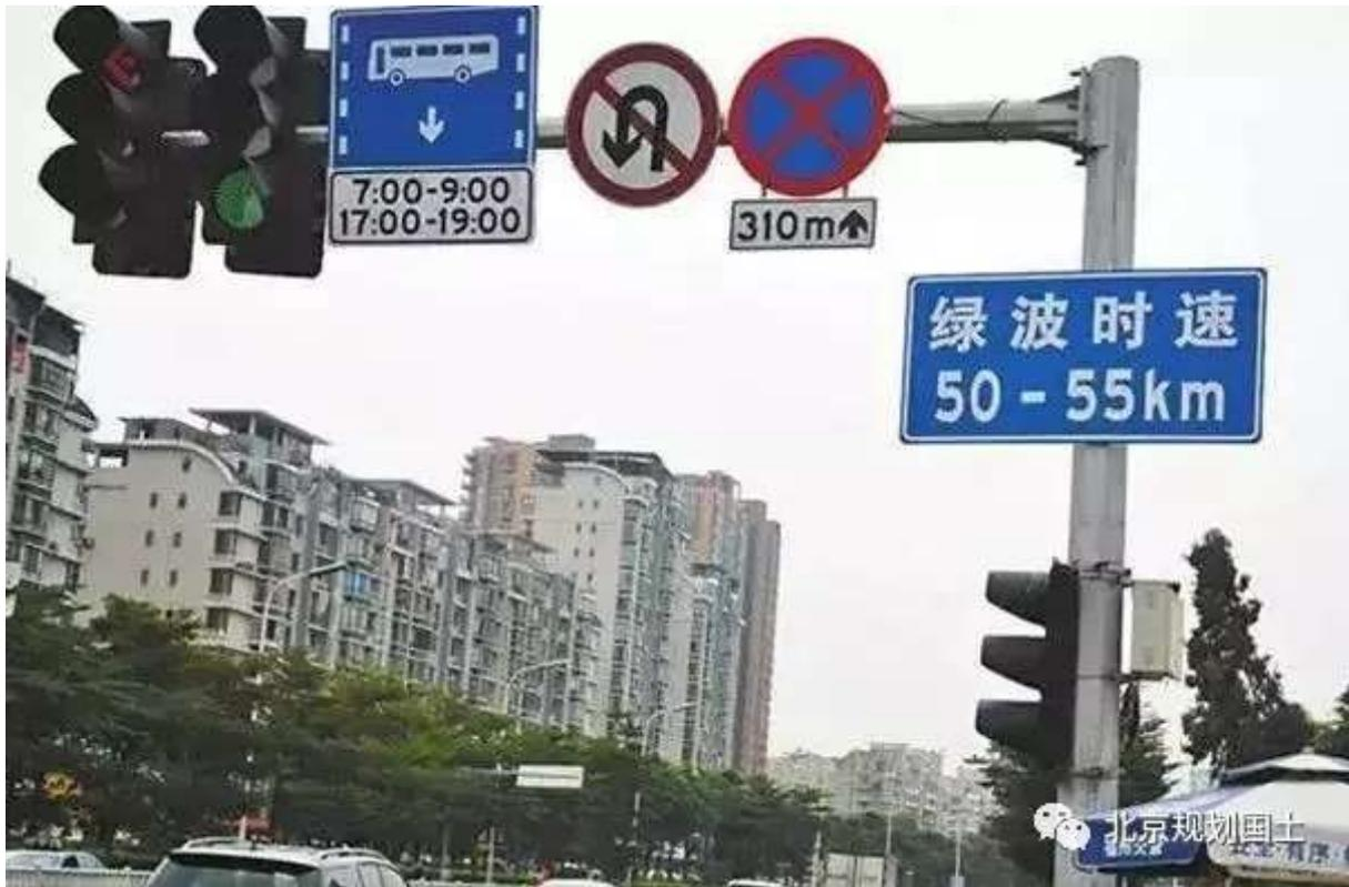
绿波带让传统信号灯进化为“城市医生”，为城市“毛细血管”疏堵，提升社会的整体出行效率。随着机动车辆不断增加，城市化进程加快，城市交通开始凸现潮汐现象：早晨进城方向交通流量大，而晚上出城方向交通流量大。为畅通城市道路交通，缓解潮汐式拥堵问题，各地开始向智能交通系统要“药方”，其中，“绿波带”就是一剂良方。
